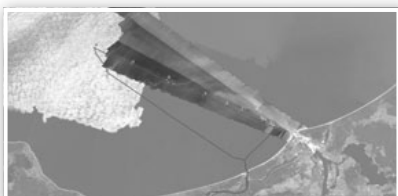
Attālās izpētes lidojumu līnijas virs Daugavas ietekas Baltijas jūrā un lauka izpētes datu ievākšanas punkti. Lidojuma līniju krāsu atšķirības raksturo ūdens optiskās īpašības.
