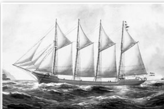
Gafelšoneris (ar motoru) „Eurasia” – tipisks Latvijas piekrastē izmantotais takelējums, kura apkalpošanai nevajag lielu komandu. Pēdējais Latvijā būvētais lielais koka zēģelnieks. Nolaists ūdenī 1925. gadā Plienčiemā, 513 BRT, pēdējais un izcilākais ievērojamā latviešu kuģu būvmeistara M. Morgenšterna devums latviešu „zemnieku flotei”.
