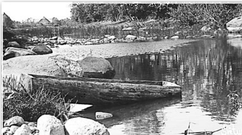
Vienkoce, primitīvākais laivas tips – no vienlaidu balķa iztēsta siles veida laiva ar stabilizatoriem („spārniem”) sānos.
