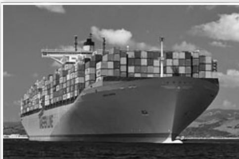
Mūsdienu konteinervedēji pārsniedz ar saviem gigantiskajiem izmēriem: to garums sasniedz gandrīz 400 m un platums 56 m.
