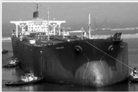
Attēlā redzams viens no pasaules lielākajiem tankkuģiem. Malaccamax tipa kuģu garums sasniedz 470 metrus, platums 60 metrus, bet iegrimē tiem ir 20 metru.
