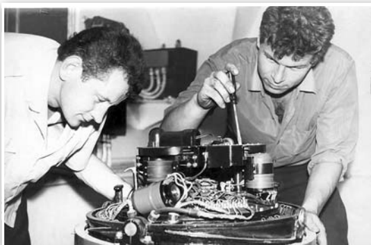
Tiek remontēts žirokompas.
