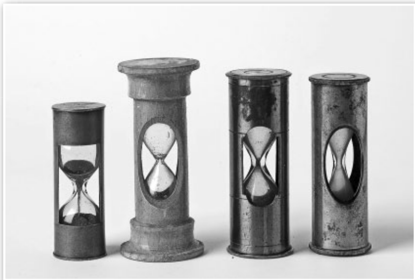
4. Smilšu pulksteņi kuģa ātruma mērīšanai ar rokas lagu (14 sek.), 19. gs. Pirmais no kreisās – Eduarda Štāla 1974. gadā muzejam dāvinātais pulkstenis.
