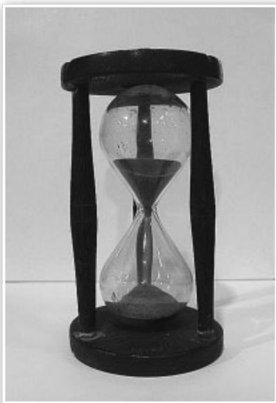
3. Smilšu pulkstenis kuģa ātruma mērīšanai ar rokas lagu (14 sek.), 19. gs.
